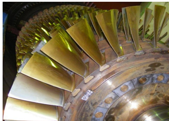
Рабочие лопатки компрессора ГТК-25И с полифункциональным покрытием TiN
