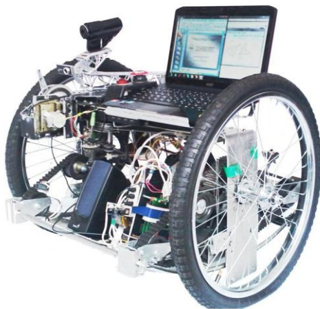
Роботы в составе МАРТП: прототип одноосного робота-сапера (робот-тральщик)
