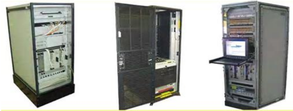
Серверы, разработанные совместно с ФГУП «ФНПЦ НИИИС» для системы верхнего блочного уровня АСУ ТП АЭС
