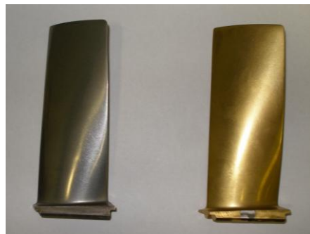
Рабочие лопатки компрессора НК-12 с полифункциональным покрытием TiN
