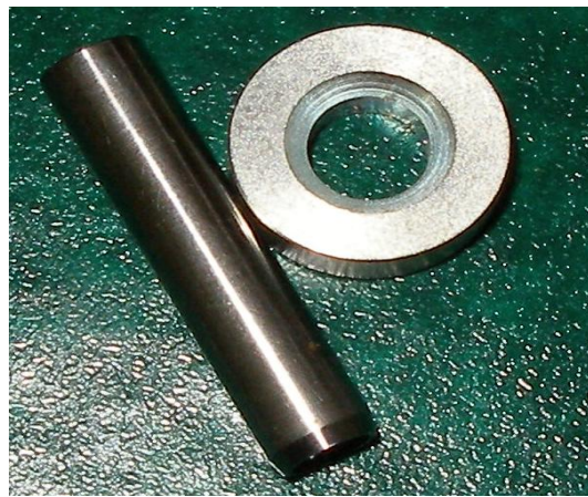
Пара трения «полуось – подшипник»
