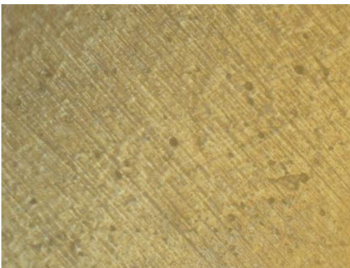
Микроструктура поверхности покрытия TiN
